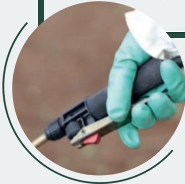
Certifique-se de que o regulador de pressão (gatilho) esteja operando corretamente, garantindo um jato uniforme para uma melhor distribuição. Se o jato não estiver uniforme e apresentar falhas, desmonte o bico do pulverizador e com o auxílio de uma escova ou pincel limpe-o.
